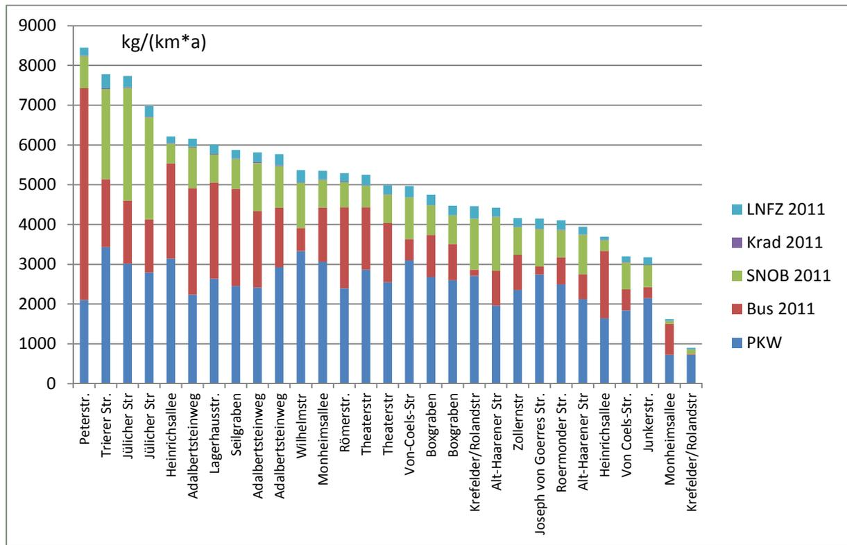
**Abb. 3.2/6: Quantitative Darstellung der Emissionsanteile der einzelnen Fahrzeuggruppen an den verkehrsbedingten NO<sub>x</sub>-Emissionen in der Aachener Innenstadt.**
