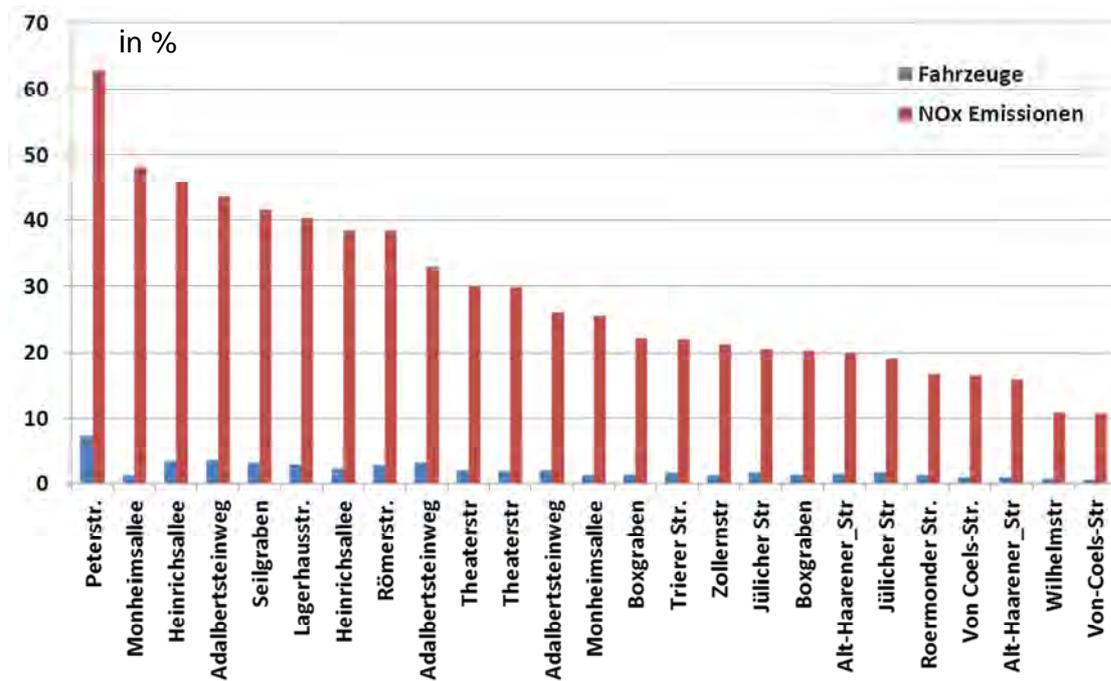
Abb. 3.2/5: Vergleich der prozentualen Anteile der Busse am Verkehrsaufkommen und an den verkehrsbedingten NO<sub>x</sub>-Emissionen an den untersuchten Straßenabschnitten
